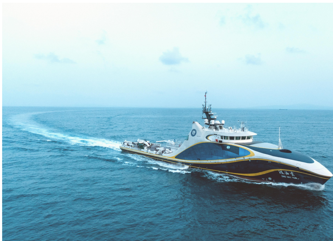
图1-7 全球首艘具有远程遥控和开阔水域自主航行功能的科考船母船“珠海云”号 (南方海洋科学与工程广东省实验室(珠海)供图)
