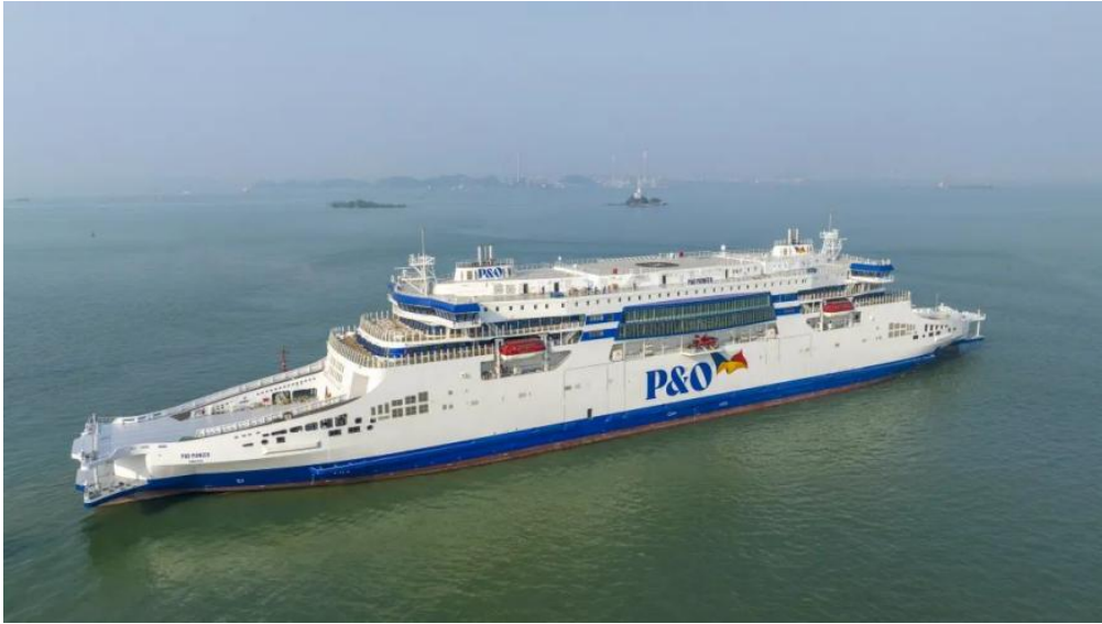
图 2-2 大容量电池混动双头豪华客滚船 2 号船“P&O LIBERTE (P&O 自由)”号 (广州市规划和自然资源局供图)
