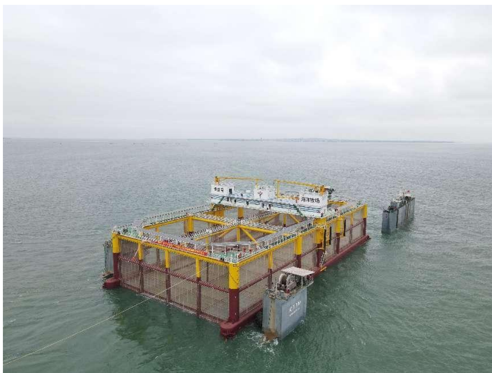
图 2-5 6 万方矩形可移动柱稳式养殖平台“恒焱 1 号” [南方海洋科学与工程广东省实验室（湛江）供图]
