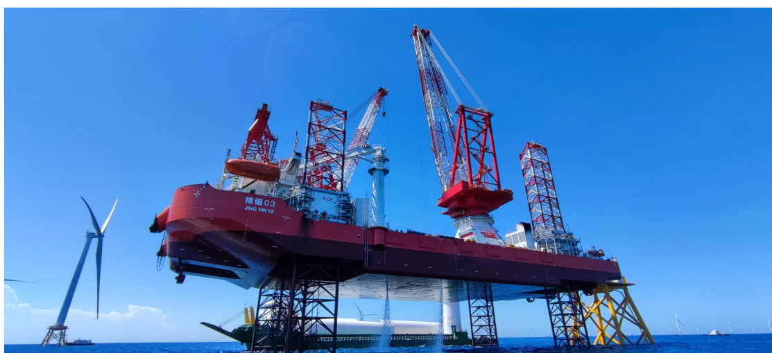
图 3-4 油电混合动力自航自升式海上风电安装平台“精钢 03”号 （夏惠峰摄 广东精钢海洋工程股份有限公司供图）
